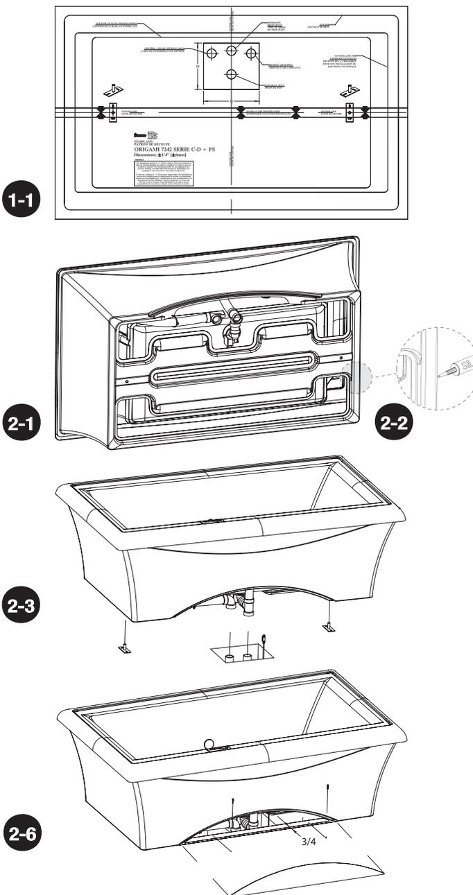
**NOTE :** Pour l'installation de l'Origami autoportant Série Design sur une dalle de béton ne permettant pas le passage du tuyau pour l'entrée d'air du bain : un trou de 1 5/8" de diamètre doit être percé dans la jupe. **IMPORTANT:** Percer le trou 1 1/2" au dessus du sol et protéger la baignoire avec une planche de bois placée derrière l'endroit à percer.
