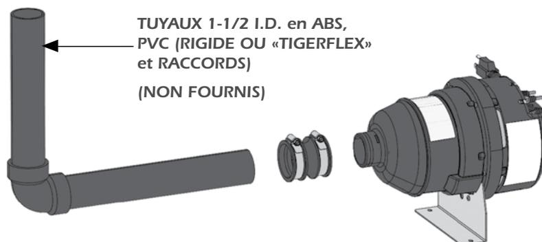
**INSTALLATION DE LA TURBINE À DISTANCE - BRANCHEMENT ÉLECTRIQUE (THERMOMASSEUR)**
